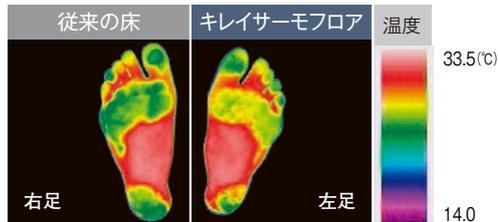
左図は左足をキレイサーモフロアに、右足を従来の床に15秒間接触した後の足裏の温度分布をサーモグラフィで示したものです。
