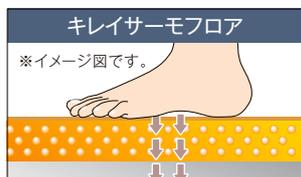
中空バルーンを含む独自の断熱層によって、足裏から逃げる熱を少なくして、冷たさを感じにくくします。
