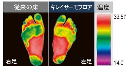
左図は左足をキレイサーモフロアに、右足を従来の床に15秒間接触した後の足裏の温度分布をサーモグラフィで示したものです。
