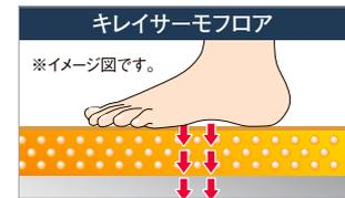
独自の断熱層によって、足裏から逃げる熱を少なくして、冷たさを感じにくくします。
