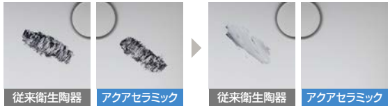
疑似汚れを塗布 洗浄・拭き取り後
