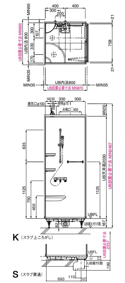
※スラブ上ところしの場合の据付高さ調整範囲: 187 ~ 227mm (セレクトパーツで据付高さを変更できます。詳細は P.144 をご参照ください。)
