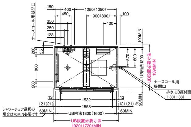
※ UB設置必要寸法にドア設置必要寸法は含んでいません。ドア納まりについての詳細は必ず矩計図(縦断面図)をご確認ください。
