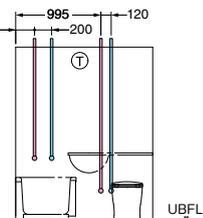
■凡例 (M) (T).....給水・給湯管取出位置記号 (D).....雑排水管取出位置記号 (S).....汚水管取出位置記号
