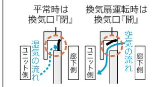
カビが付きやすいドア縁のゴムパッキンをなくし汚れがたまりやすいドア下の換気口をドア枠の上部に移動しました。
