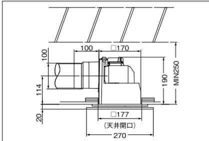
換気扇をユニットバスルームの天井に直接取り付けの場合は、換気グリルの位置に取り付けるよう設計してください。
