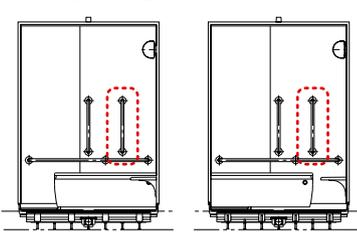
浴槽移動後のネジの取付穴は同梱のネジキャップにて隠す仕様となります。
