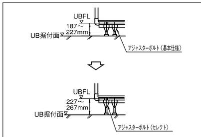
図のように、UBFL~UB据付面までが267mm以下であれば、アジャスターボルトにて調整できます。
