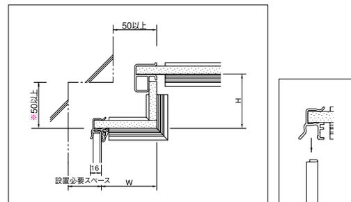
(注) 建築躯体とのクリアランス寸法は組み立て上のスペースと建築誤差を吸収するための寸法ですので必ず確保してください。特に※印の50以上は天井パネルを上から壁パネルにはめ込むため絶対に必要です。
