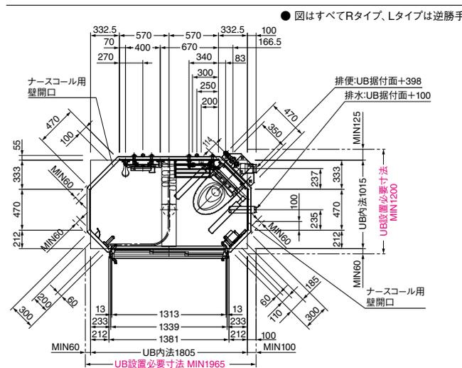
※UB設置必要寸法にドア設置必要寸法は含んでいません。ドア納まりについての詳細は必ず短計図(縦断面図)をご確認ください。
