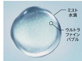
ウルトラファインバブルとは、直径1μm未満の非常に微細な泡です。
