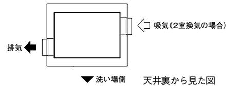
・本体は180°回転させて取り付けることができますが、推奨位置に設置した時に比べて、暖房性能が悪くなる場合があります。その場合は吹き出し口の向きも180°回転させてください。また、ランドリーパイプの位置も50mm程度、壁側にずらしてください。
